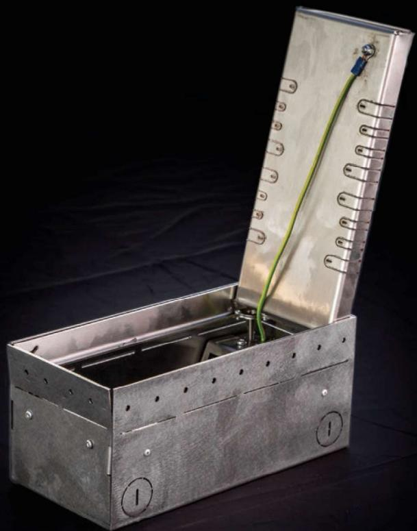
*Hidden Box krabice je vyrobena z kvalitní nerezové oceli o tloušťce 1 mm. Skládá se ze dvou částí, těla krabice a výškově seřiditelného rámu s vyklápěcím víkem. Při používání je víko zavřené a kabely pro spotřebiče jsou vedeny otvory ve víku. Pevné tělo krabice se instalací a používáním nedeformuje a je tak zaručena vysoká provozní spolehlivost.*
